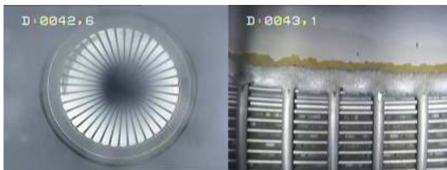
Figure 6 : Top crépines à -43 m
