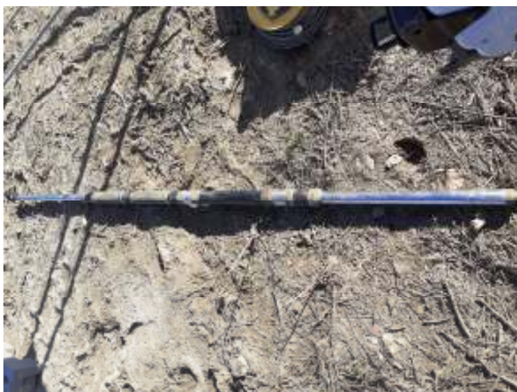
Figure 15 : Sonde FWS pour le contrôle CBL
