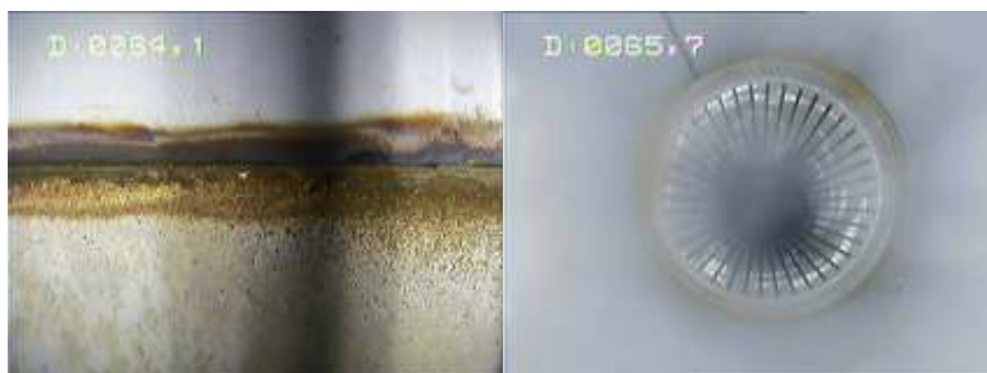
Figure 13 : 3 ème tube plein intercalé entre -64 et -66m
