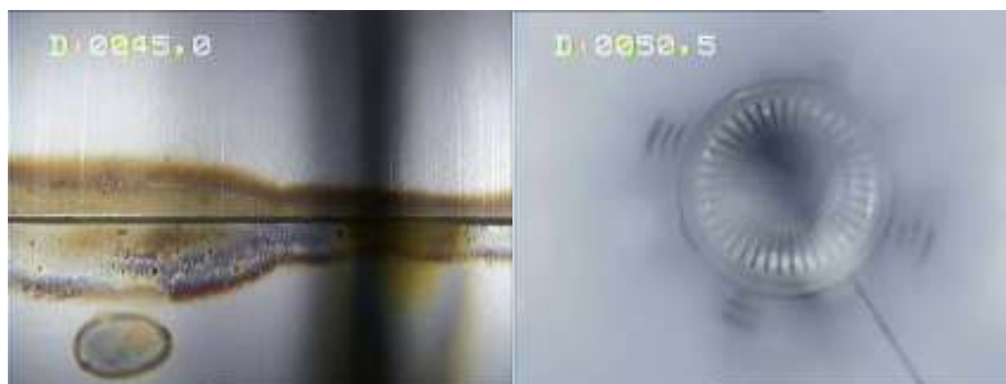
Figure 11 : 1 er tube plein intercalé entre -45 et - 51m
